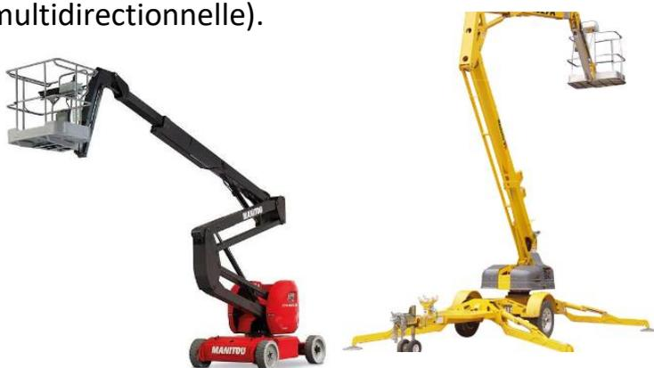
*type 2 : la translation peut être commandée par un organe situé sur le châssis ou dans le porteur, alors que la plate-forme de travail n'est pas en configuration de transport (position basse) ;*
